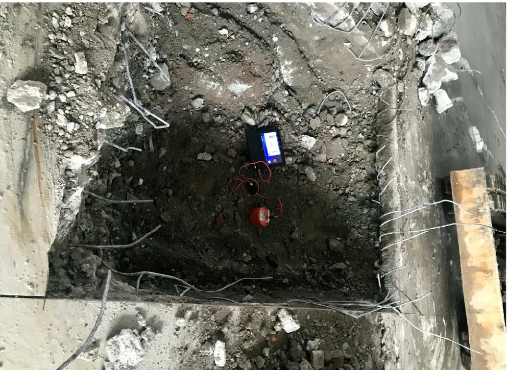
Strumentazione sismica HVSR e MASW, particolare
