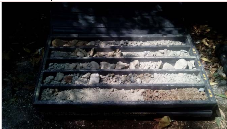
Cassetta Sondaggi – profondità 0-5 metri
