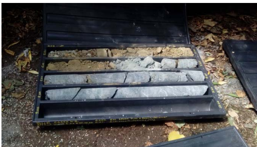
Cassetta Sondaggi – profondità 5 -9 metri
