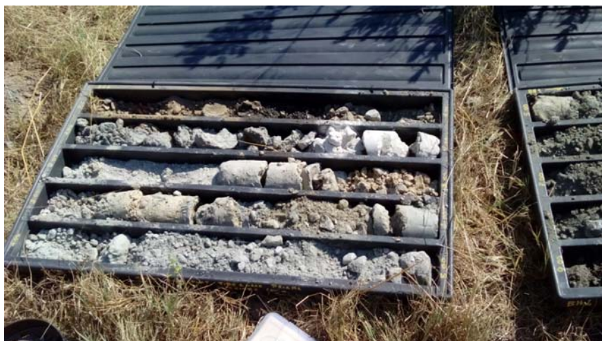
Cassetta Sondaggi – profondità 0-5 metri
